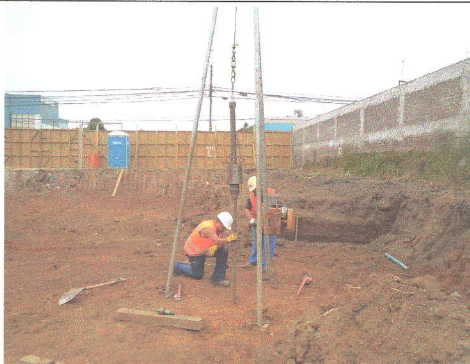
FOTOGRAFIA 15: EJECUCIÓN DE SONDAJE N°3
